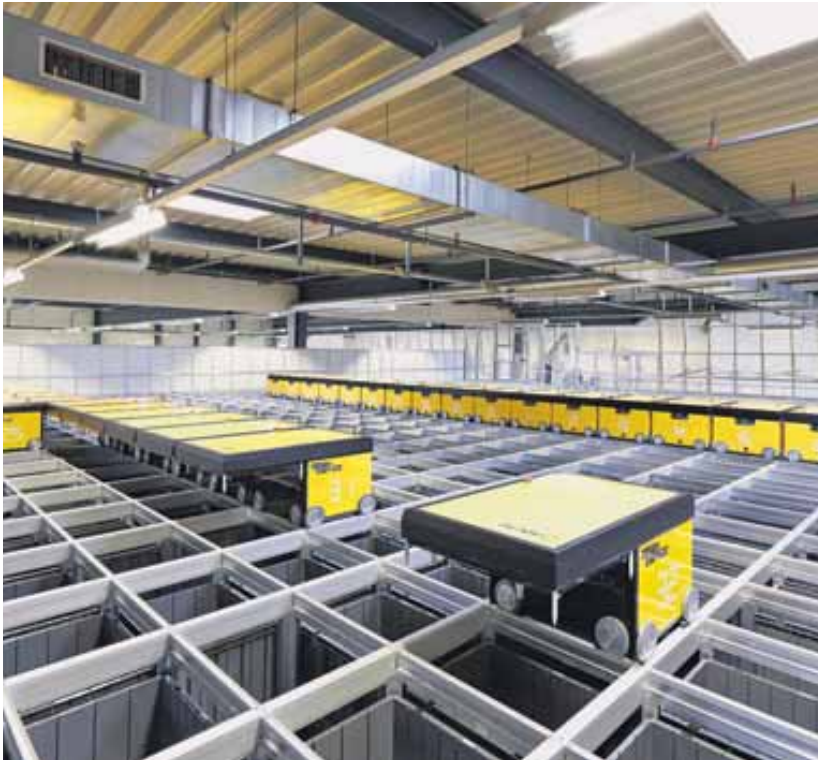
Lautlos gleiten gelbe, elektrisch betriebene Roboter über eine schachbrettartige Schienenstruktur.
