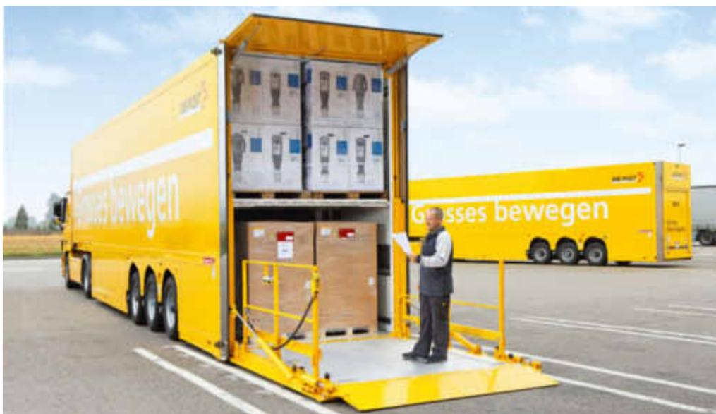
Diese Jumbos machen Freude: 28 Doppeldecker-Sattelaufleger transportieren für die Post Paketsendungen. Weil sie auf zwei Etagen beladen werden können, bieten sie 50 Prozent mehr Ladekapazität. Das rechnet sich – dank der eingesetzten Doppeldeckerflotte spart die Post jährlich über 420 000 Liter Dieseltreibstoff ein und vermindert ihren CO<sub>2</sub>-Ausstoss um 1100 Tonnen. *an*
