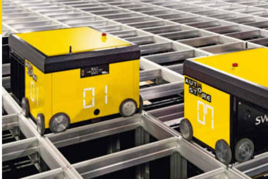
Roboter transportieren die abgerufenen Waren von der Kommissionierungsanlage zu den Mitarbeitenden.
