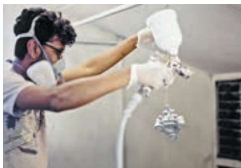
4 La nichelatura impermeabilizza tutti i pezzi.
