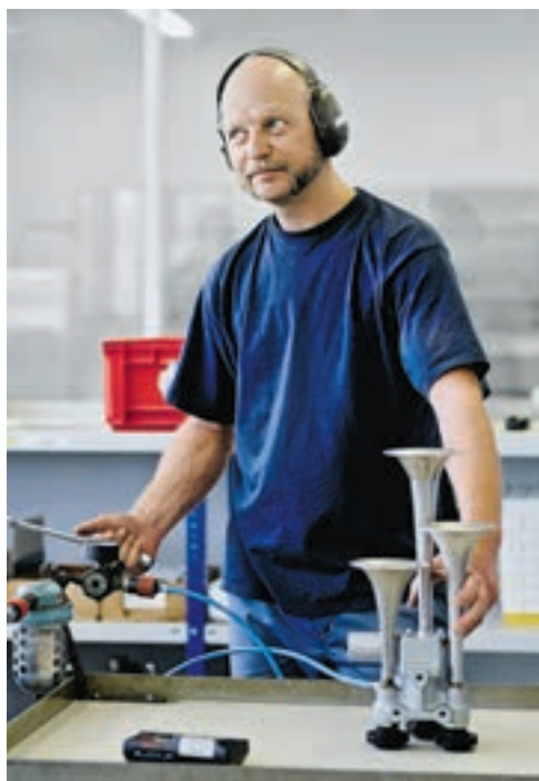
7 Alla fine, il corno postale viene accordato. Non a orecchio, ma misurando le frequenze.
