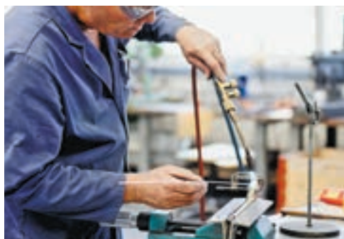
2 L'ottone viene laminato e saldato.
